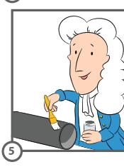
**5** - Нанесите kleящее вещество ровным слоем на продольные поверхности обеих соединяемых частей (наружную поверхность трубы и внутреннюю поверхность фитинга) с помощью аппликатора или грубой кисти соответствующих размеров. Клей должен быть нанесен на всю длину склеиваемых поверхностей.
